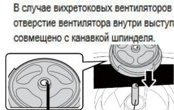
Выпуклая внутренняя часть отверстия вентилятора
